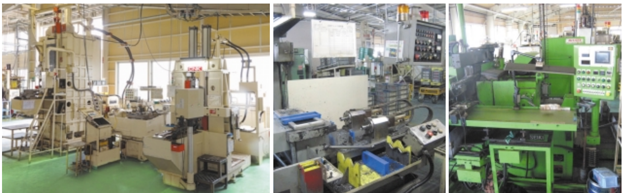
特殊加工設備（左から、カウンターフローでのスブライン加工、ガンドリルでの深穴加工、センターレスでの研磨加工）
