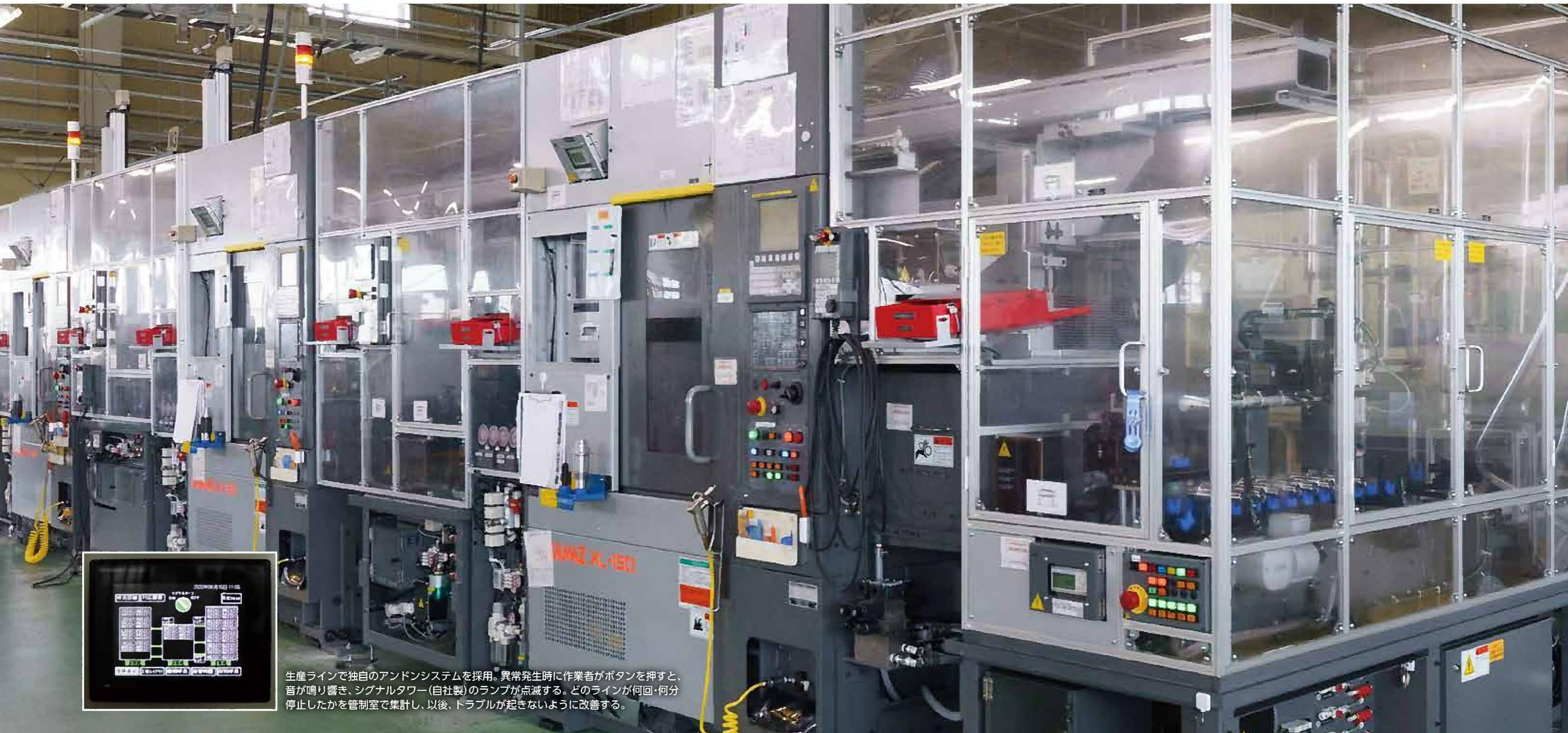
生産ラインで独自のアンドンシステムを採用。異常発生時に作業者がボタンを押すと、音が鳴り響き、シグナルタワー(自社製)のランプが点滅する。どのラインが何回・何分停止したかを管制室で集計し、以後、トラブルが起きないように改善する。
